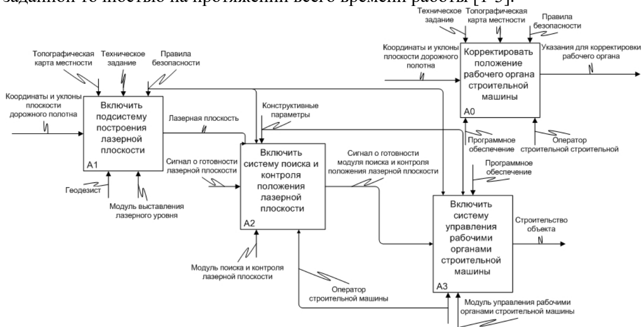
Рис. 1 – Принципиальная схема работы системы нивелирования для строительной техники
