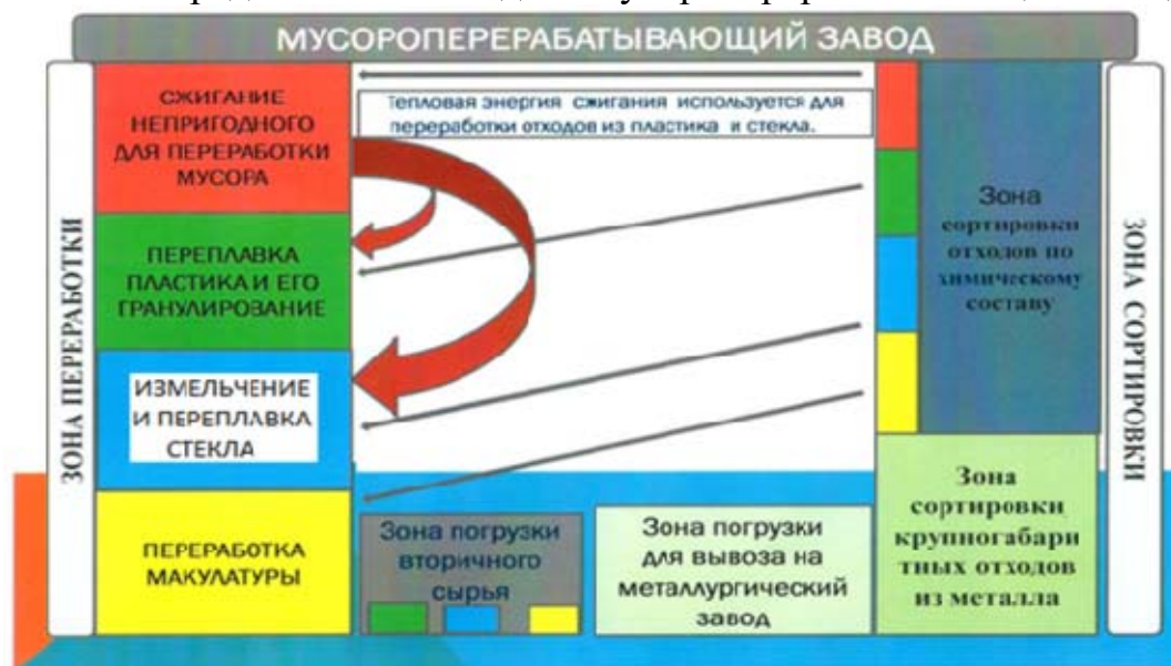
Рис. 1 – Предлагаемая схема мусороперерабатывающего завода
