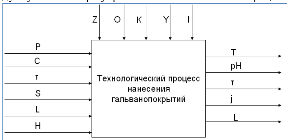
Рис. Представление ТП нанесения гальванопокрытий как параметрической модели
