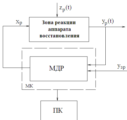
Рис. 1. Структурная схема экспериментального исследования двухпозиционного регулирования температуры зоны реакции процесса восстановления
