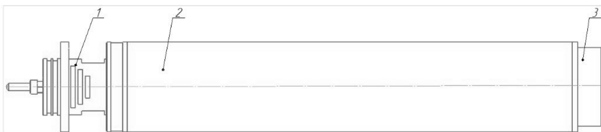
Рис. 2. Корпус БП: 1-головка; 2-гильза; 3-заглушка
