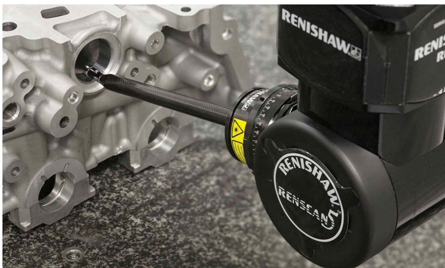
Рис. 4. Контроль отверстия с помощью щупа Renishaw
